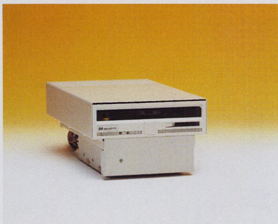
Die Caddy-Station ersetzt die TT- oder Mega STE-Festplatte und bietet Platz für ein zusätzliches 5,25-Zoll-Laufwerk
